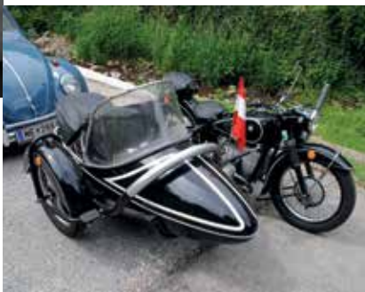
Beiwagen aus einem Abwurf tank
