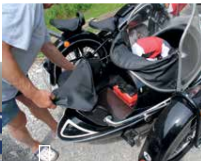
Beiwagen aus einem Abwurf tank
