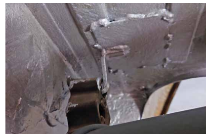
Eigenkonstruktion ganz hinten; zusätzlicher Halter für den Endtopf
