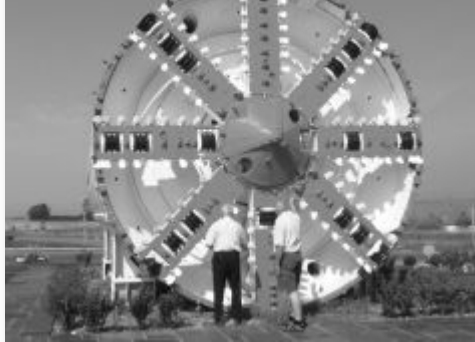
Bohrkopf für den Eurotunnel unter dem Ärmelkanal
