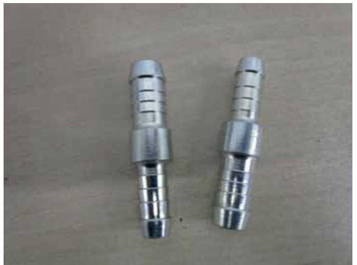
17. Reduzierstücke für Schläuche und Leitungen, müßt Ihr ausprobieren, aber 1 mm bekommt man mit Rostlöser (macht Gummi geschmeidig) aus gelichen.
