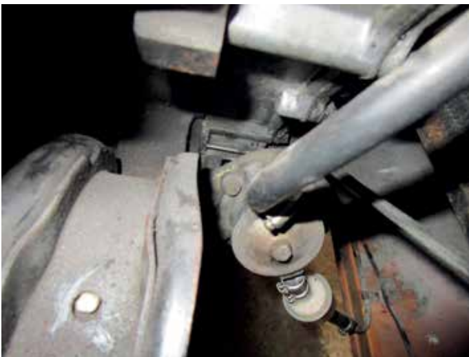
16. Schlauch zum Vergaser, von der mechanischen Benzinpumpe abziehen und auf die Druckseite der elektrischen Kraftstoffpumpe anschließen. (habe ich hier und heute noch nicht gemacht, da ich im Winter die Anleitung geschrieben hab, es war a.... kalt, bitte um Verständnis)
