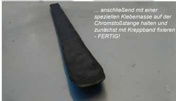
Unkonventionelle Lösung für die Gummileisten: vergammelten Metallstreifen raus, gereinigten Hohlraum mit schwarzem Acryl auffüllen...
