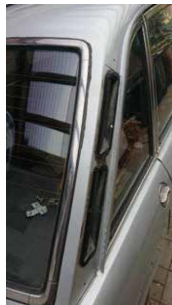
Wieder saubere Dachkante - hier ist prima zu erkennen, wie gut Hammerite GLÄNZEND SILBER zu VW L96D passt
