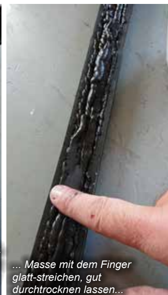
... anschließend mit einer speziellen Klebemasse auf der Chromstoßstange halten und zunächst mit Kreppband fixieren - FERTIG!
