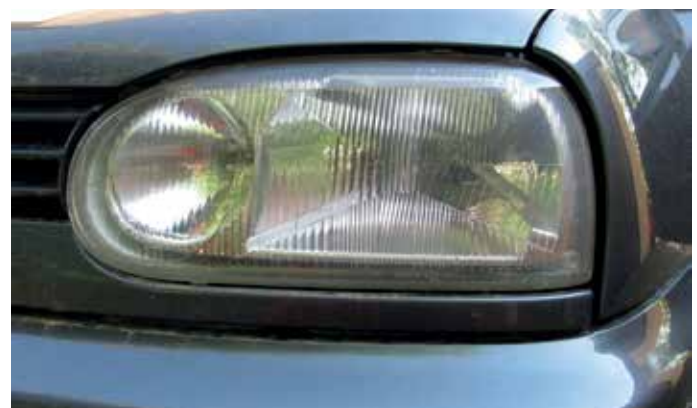
Konventioneller Scheinwerfer mit Streuscheibe (VW Golf III); je eine H1-Einfadenlampe für Fernlicht (innen) und Abblendlicht (außen) – diese „Edelausführung“ sieht nicht nur schicker aus, sie ermöglicht auch den gleichzeitigen Betrieb von Fern- und Abblendlicht
