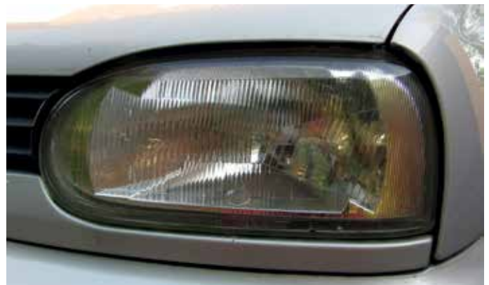
Konventioneller Scheinwerfer mit Streuscheibe (VW Golf III); eine H4-Zweifadenlampe für Fern- und Abblendlicht
