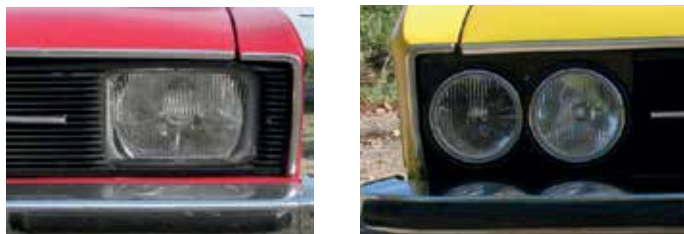
Zweimal VW K 70: Links Bilux-Zweifaden, rechts Halogen (2x H1)
