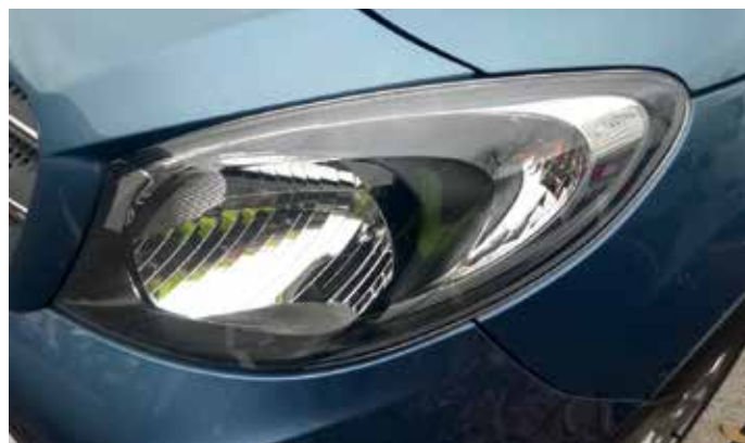
Scheinwerfer mit Freiformreflektor und glatter Abschlusscheibe (Mercedes-Benz Citan); eine H4-Zweifadenlampe für Fern- und Abblendlicht
