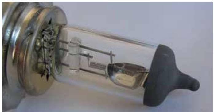
H4-Biluxlampe in Großaufnahme: Im Glaskolben links die Glühwendel für Fernlicht, rechts die Glühwendel für Abblendlicht (nach unten durch eine Abdeckpfanne abgedeckt). Daraus ergeben sich die rechtsabgebildeten Strahlengänge (Abb. unten) für Fernlicht (links) und Abblendlicht (rechts).
