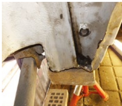
Rechter hinterer Radkasten: nach vorn nahezu kein Rost
