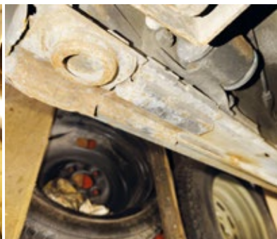
Der linke Schweller: oberflächlicher Rost
