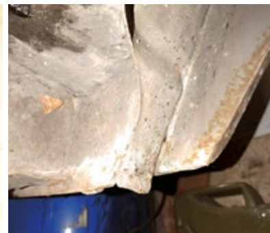
Im rechten Radkasten ist die Endspitze nicht durchgerostet
