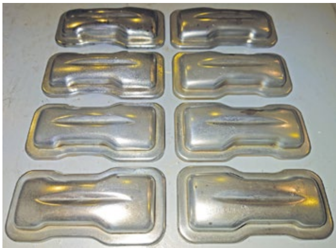
Die auf Hochglanz polierten Ventildeckel verraten die verwandtschaftliche NSU-Herkunft des K 70
