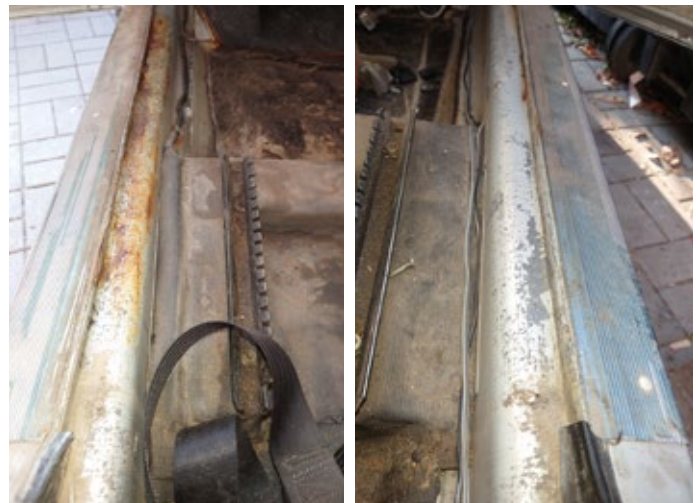
Schweller und Bodenblech Fahrer- und Beifahrerseite: das Braune auf den Fotos ist selten Rost - meistens abgefärbtes Bitumen von Dämmmatten bzw. Profilmummikleberreste.
