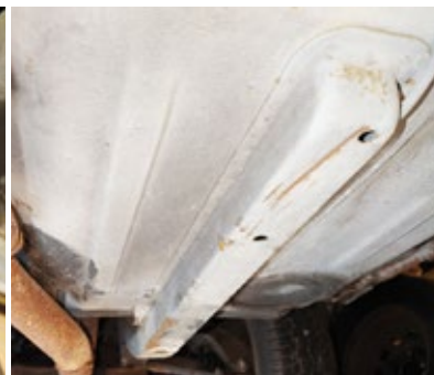
Die empfindlichen Längsträger machen auch nach 50 Jahren noch einen stabilen Eindruck...
