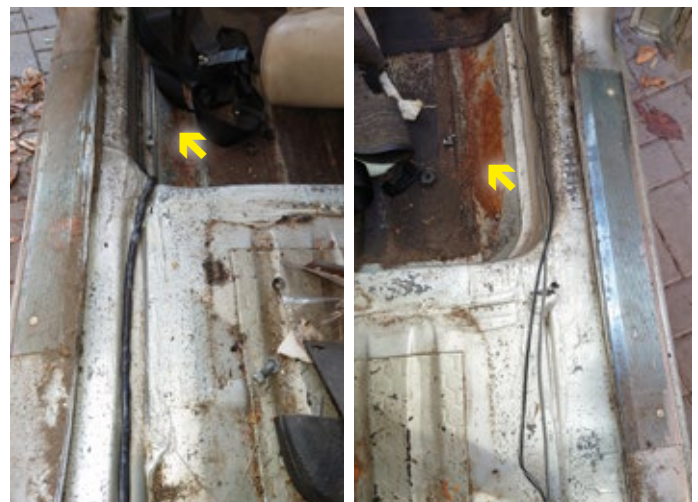
Hinterer Fußraum links und rechts: hier war es tatsächlich etwas rostig... aber nur oberflächlich
