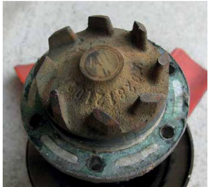
**Bild 3:** Pumpenrad des K 70: Simplex, aber für den 1,6-Liter-Motor ausreichend.
