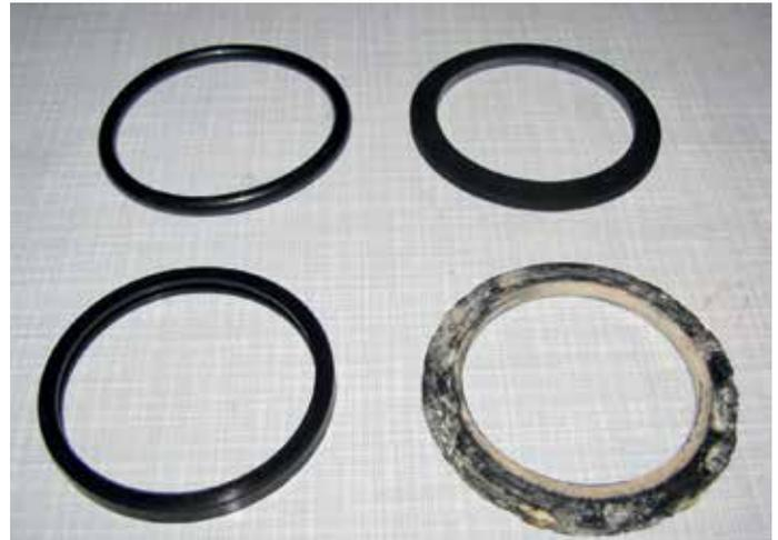
**Bild 6:** Thermostatdichtungen.
