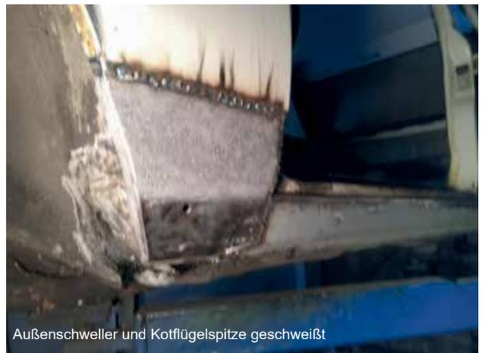
Außenschweller und Kotflügelspitze geschweißt
