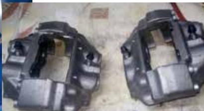
Bremssättel zusammengebaut und mit hitzebeständigem Klarlack lackiert
