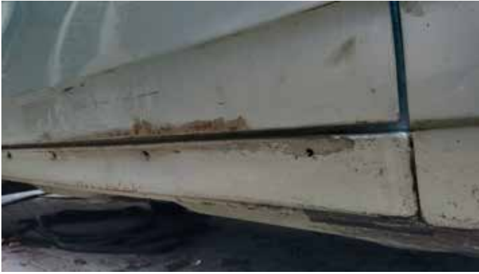
1. So sieht sie aus, die Schramme im Schwellerblech
