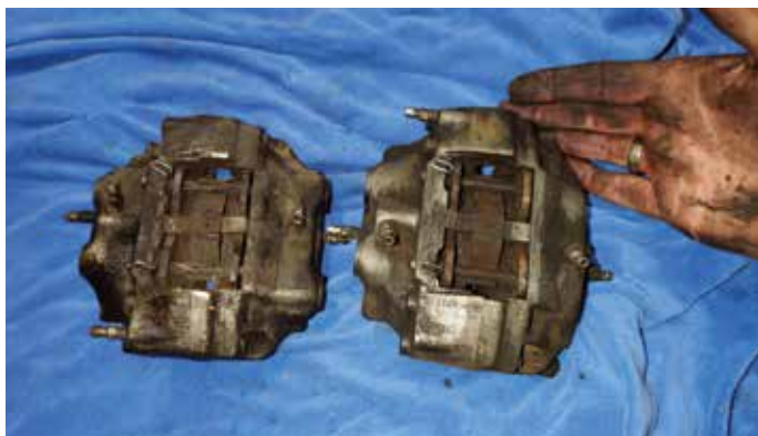
Dreckiger Job: Bremssättel ausbauen
