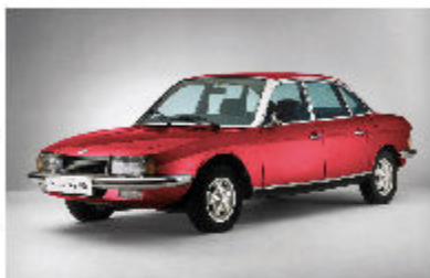
Der NSU Ro 80 mit Wankelmotor.
