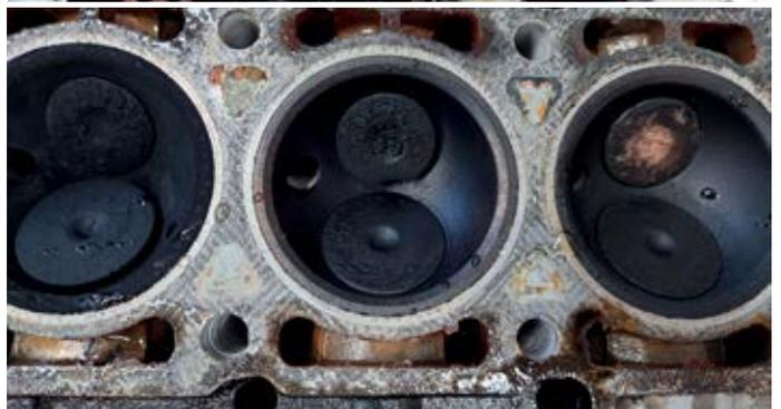
*Das Auslaßventil des mittleren Zylinders ist verbrannt fehlt ein Stück. Sein Fehlen verursacht, dass hier kein Kompressionsdruck mehr aufgebaut werden kann. Deshalb läuft der Motor „nur noch auf drei Pötten“. Ausgleichend dazu scheinen die weiteren Einblicke in den Motor*
