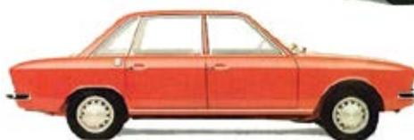
sollte. Mit wassergekühlten Frontmotoren und Vorderradantrieb kündigte der K 70 einen Paradigmenwechsel in der Welt luftgekühlter Heckmotor-Bestseller an und dafür
