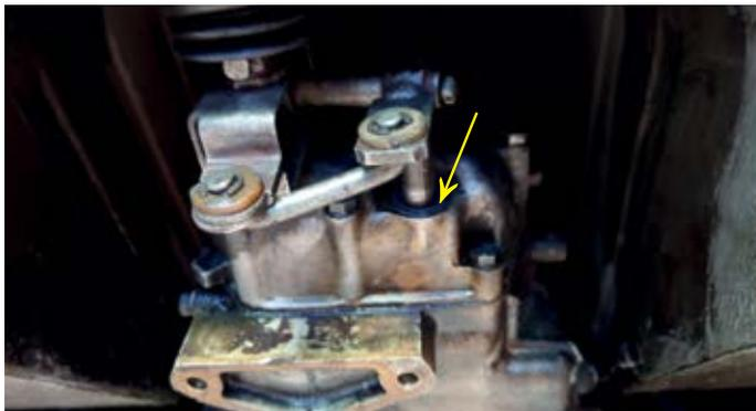
Der Dichtring an der Schaltwelle musste erneuert werden
